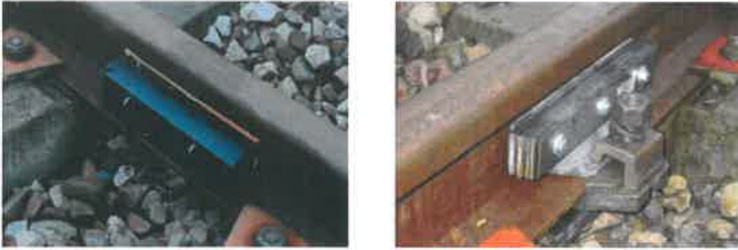
Exemples d'absorbeurs sur rail (Corus et Socitec)
