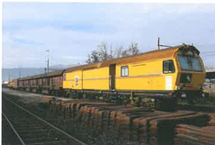
Train meuleur de rails (Scheuchzer S.A.)
