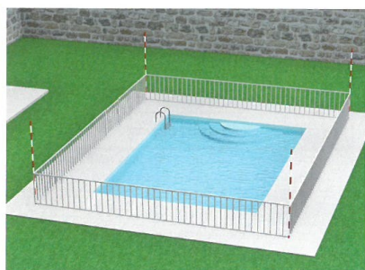
Piscine privée équipée d'une barrière de sécurité
