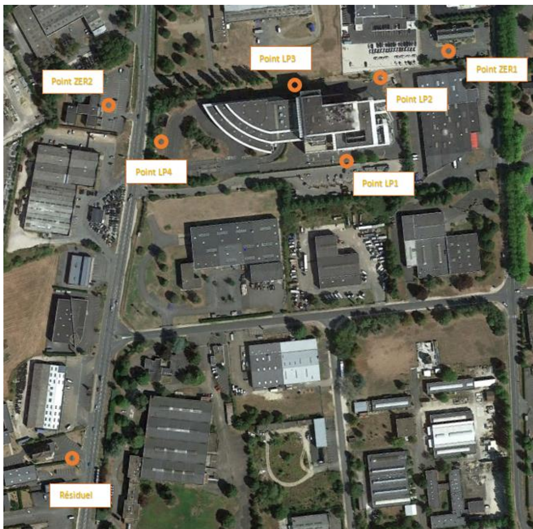
Figure 1. Localisation des points de mesures de l'état acoustique initial
